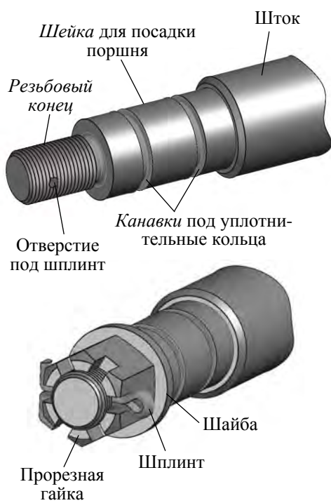
Рис. 1.29. Использование прорезной гайки, стопорящейся шплинтом, на конце штока (для удержания поршня)
