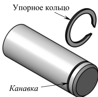
Рис. 1.7. Вал с канавкой под упорное кольцо
